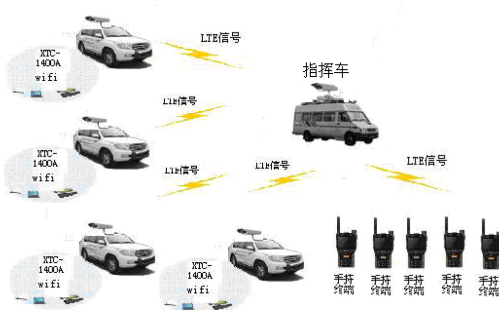
机动式 4G 应急通信系统总体架构
