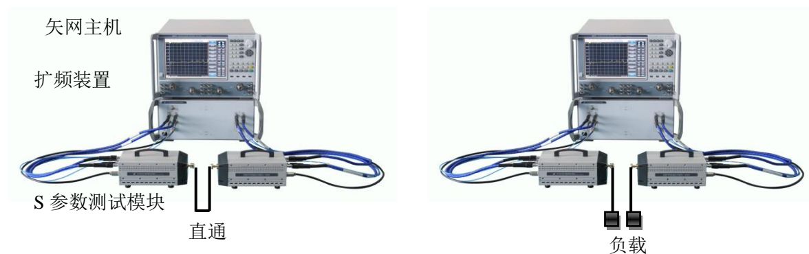
图 9-2 系统动态范围校准测试框图一 图 9-3 系统动态范围校准测试框图二
